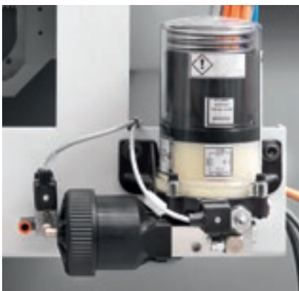
Lubricación automática cabezal de taladro BHZ 29 2L.
